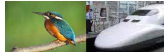
de plonger dans l'eau avec un minimum de résistance. Cette forme permet de réduire la résistance de l'air, d'augmenter la vitesse et d'atténuer le bruit lorsque le train entre dans les tunnels...
